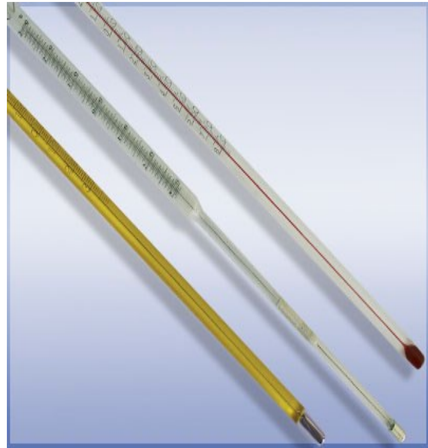
Для измерения температуры застывания и помутнения нефтепродуктов.
