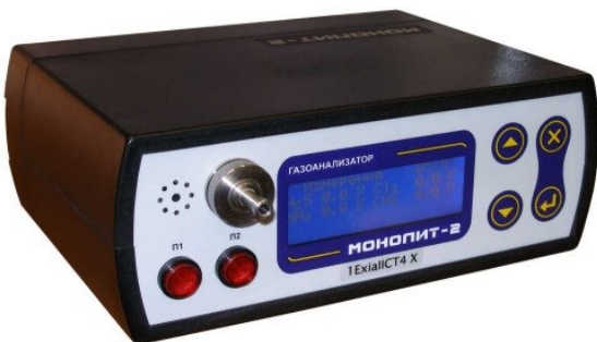
Газоанализатор токсичных газов (CO, CO 2 , NO, NO 2 , SO 2 , H 2 S, NH 3 )
